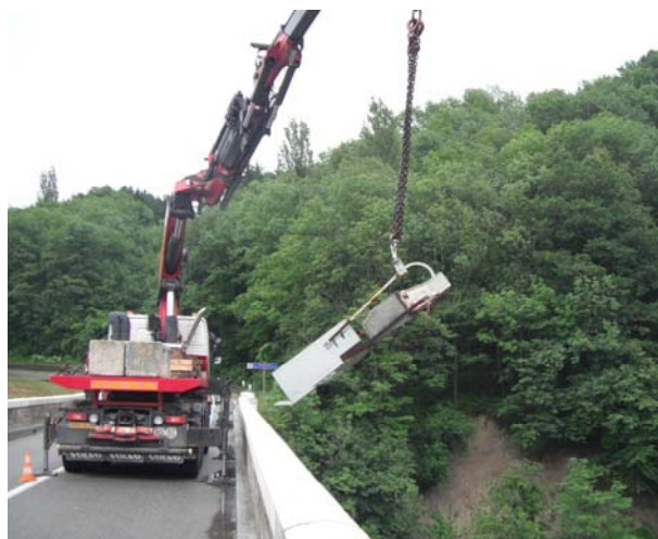
Prélèvement de la charge de fond pendant les chasses du Haut-Rhône
